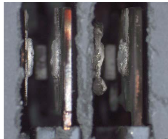
2 | Kontakte nach dem Lebensdauerende eines SFY-Relais; Belastung: DC1, 24 V DC , 6 A. Das Kontaktmaterial ist abgebrannt, und die Kontakte schließen nicht mehr
