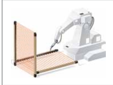
Reihenschaltung bei Flächenabsicherung
