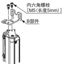
3. 安装时，请对着A部件的突起部拉出B部件的突起部。安装方向如下图所示，安装在本装置上下两侧的B部件各不相同。
