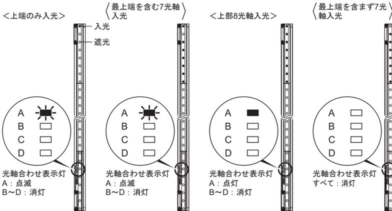
各ブロックに割り当てられた8光軸すべての光軸が入光すると、光軸合わせ表示灯が赤色点灯します。順次光軸が合ったブロックから赤色が点灯し、すべての光軸が入光状態になり、かつ制御出力(OSSD1/2)がON状態になると光軸合わせ表示灯(4個)はすべて緑色点灯に変わります。
