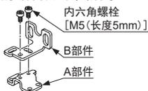
1. 用2个内六角螺栓将标准安装支架固定到本装置上。
