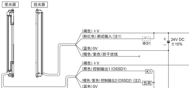
(注1)：上图是延长用电线使用SF1-CC□A的情况。使用NA40-CC□时，没有粉红色电缆。
