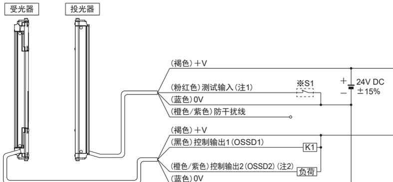
(注1)：上图是延长用电缆使用SF1-CC□A的情况。使用NA40-CC□时，没有粉红色电缆。
