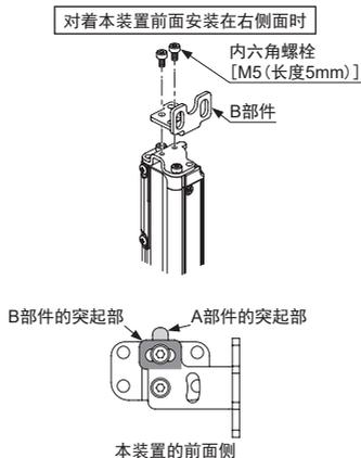
4. 请用2个内六角螺栓[M5 (请另外准备)]将安装支架临时设置在安装面上。
