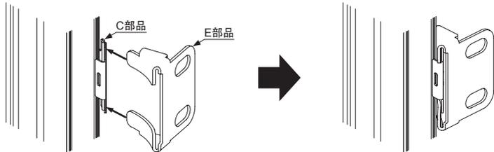
③ D部品またはE部品を六角穴付ボルト[M5(別途ご用意ください)]2本で取り付け面に設置してください。
