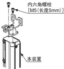
2. 安装到侧面时，请拆下B部件。
